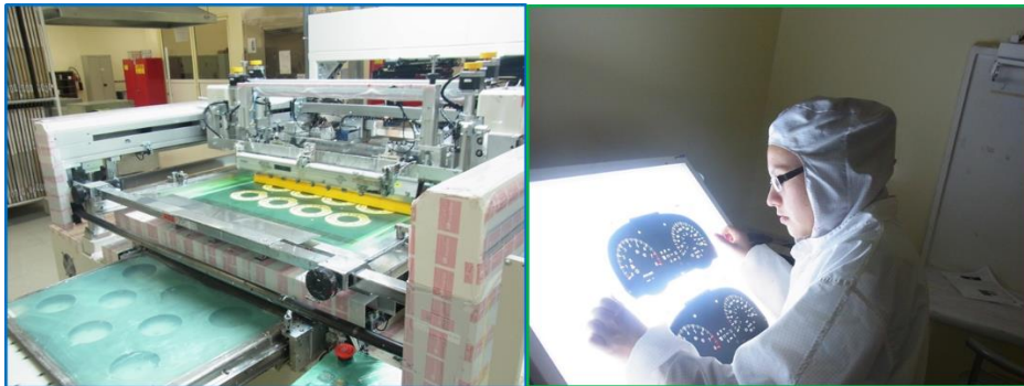
Imagen 2: fuente propia, Dial impreso en lámina de policarbonato
