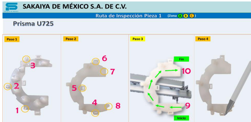
Imagen 18: fuente propia, Ruta de inspección establecida en norma de Inspección.
