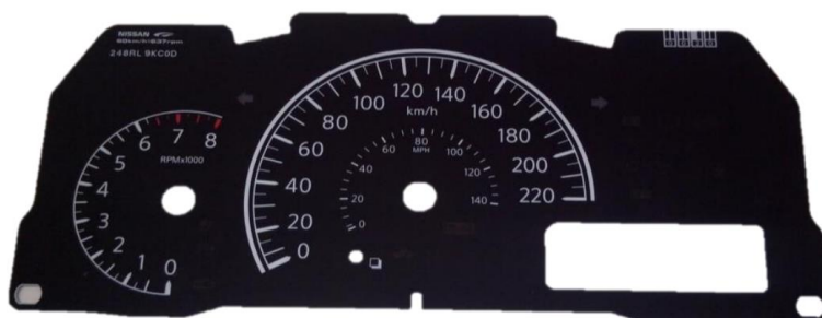
Imagen 2: fuente propia, Dial impreso en lámina de policarbonato
